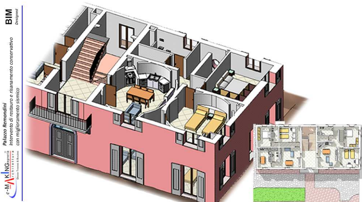
Figura 14 – Modellazione BIM - conservazione del layout architettonico esistente.
